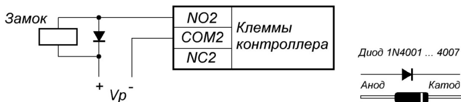
Рисунок 22. Пример подключения электромеханического замка для первой двери
