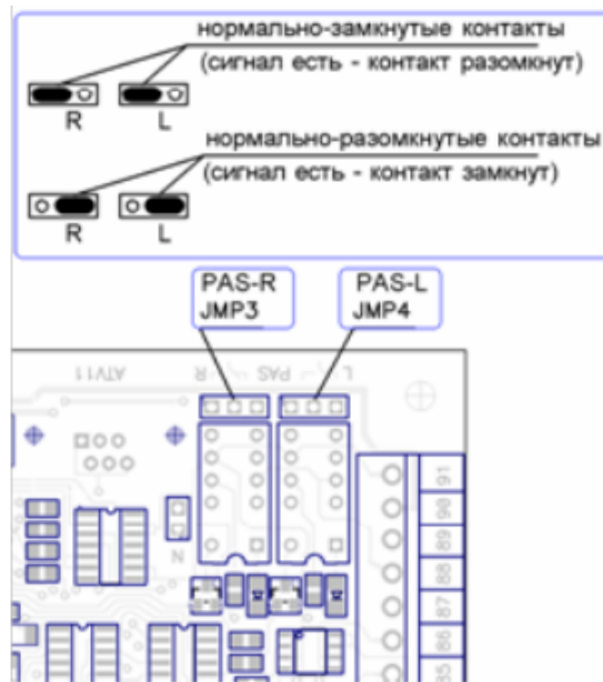
Рисунок 71. Перемычки JMP3 и JMP4 контроллера OMA 264MC1
