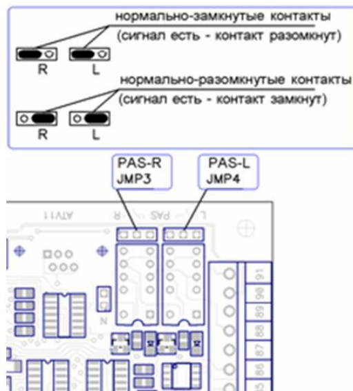
Рисунок 65. Перемычки JMP3 и JMP4 контроллера OMA-DD.958, OMA 264MC1, 866.MC2
