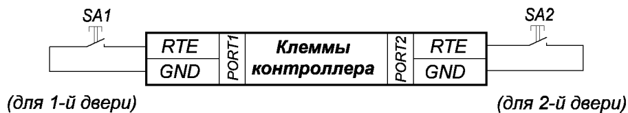
Рисунок 16. Подключение кнопок запроса прохода.
