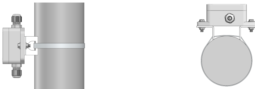
Рисунок 6. Крепление ВД на опоре ограждения
