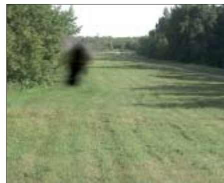
Рис. 3. Объект "насекомое" не классифицирован системой как нарушитель периметра по параметру "максимальный размер"
