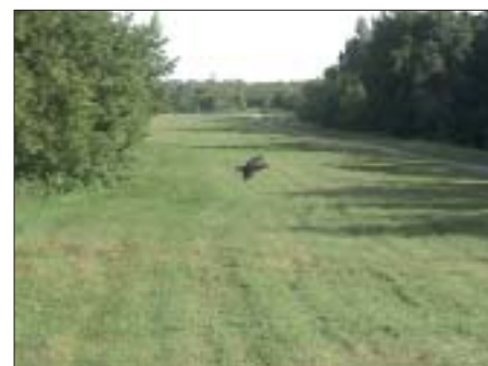
Рис. 2. Объект "птица" не классифицирован системой как нарушитель периметра по параметру "максимальная скорость"
