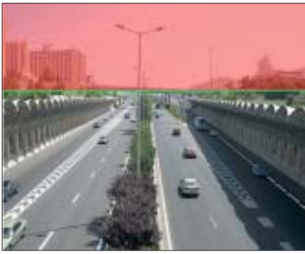
Рис. 4. Пример видимой линии горизонта (зеленая линия). Область выше данной линии может быть исключена из рассмотрения аналитическими алгоритмами (выделена красным цветом)
