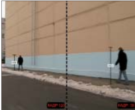
Рис. 7. Пример калибровки по маркерам высоты, где за основу калибровки выбран динамический объект
