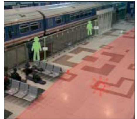
Рис. 10. Инструментарий устройства MagicBox для интерактивного определения глубины сцены
