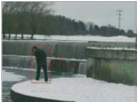
Рис. 5. Детектирование и сопровождение крупного объекта на изменчивом фоне (водопад) без маскирования зоны
