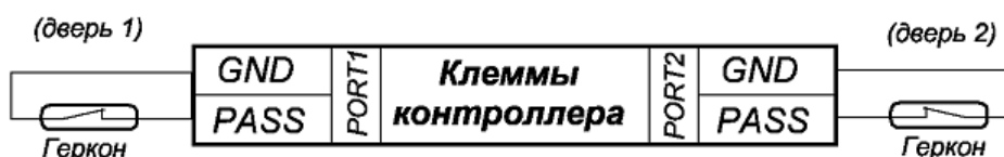
Рисунок 21. Подключение датчиков открытия для двух дверей
