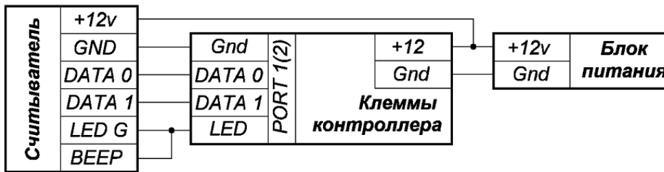
Рисунок 9. Пример подключения считывателя с напряжением питания, отличающимся от напряжения питания контроллера, или считывателей, потребляющих суммарный ток больше 500 мА
