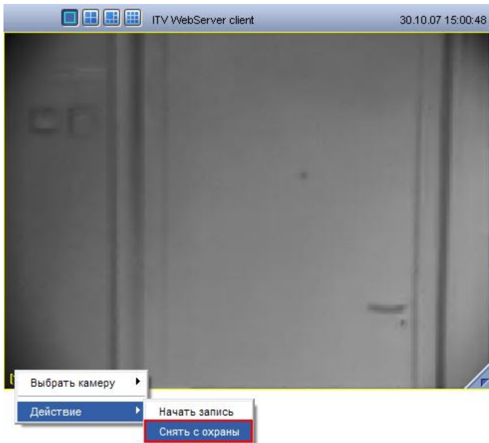
Рис. 4.16-6. Снятие видеокамеры с охраны
